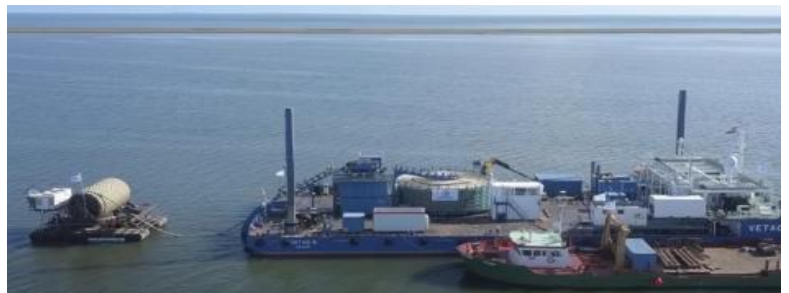
Figuur 8 Links: wadtrencher, rechts: overspoelen kabel van ponton naar haspel op rupsbanden
